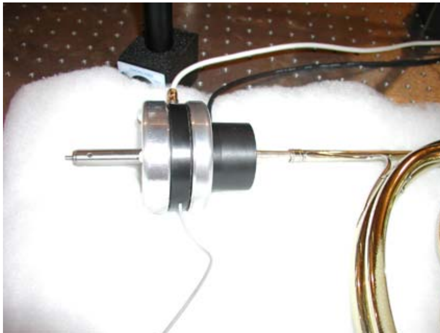
Abbildung 71 : Messkopf mit integriertem Messmikrofon
